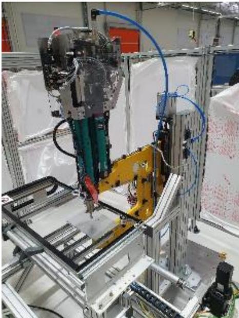
**Bild 01:** Die TOX-Maschinenzange vom Typ TZ (gelb) und ein 50 kN starkes Pressenmodul (grün) von TOX PRESSOTECHNIK sorgen in Kombination mit einem XY-Tisch samt Untergestell und Schutzzaun von MiniTec bei einem Endkunden für prozesssicheres Clinchen von verzinkten Blechen.
