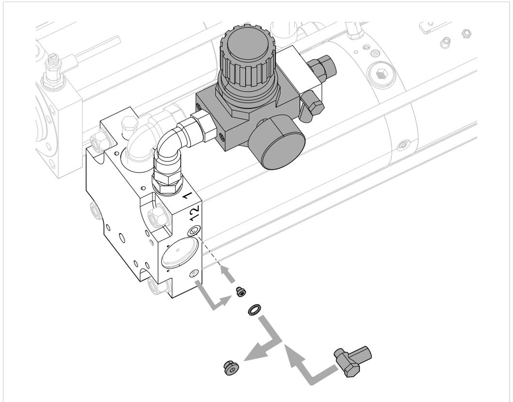
Abb. 16 Druckregelung in Krafthubleitung (Baugruppe ZDK) montieren
