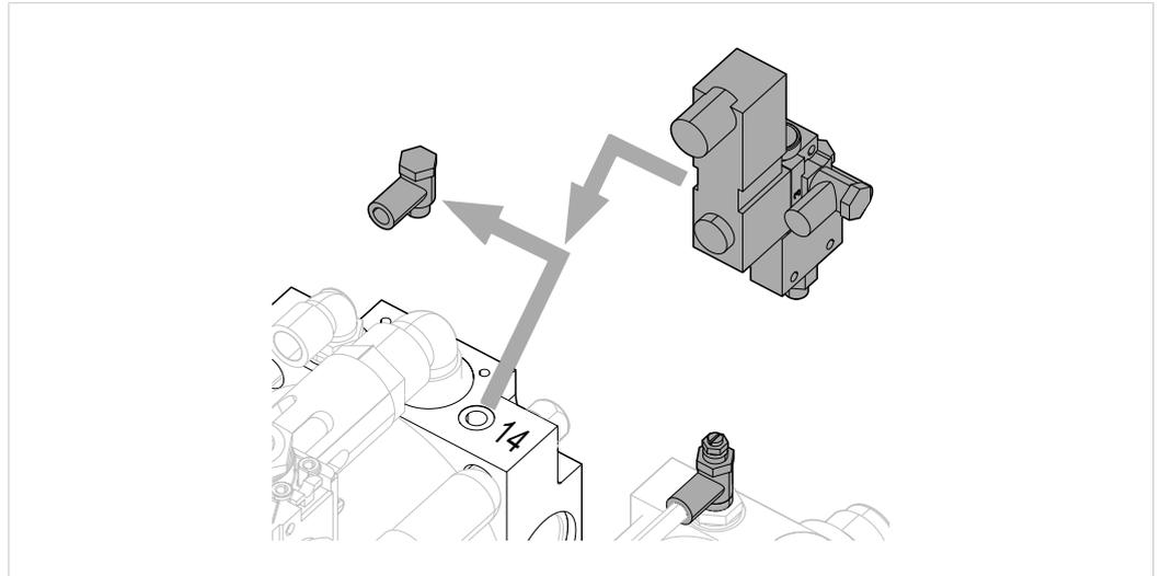
Abb. 18 Externe Krafthubfreigabe (ZKHF) und Krafthubdeaktivierung (ZKHD) montieren
