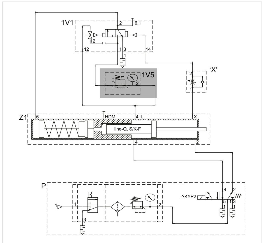
Abb. 9 Druckregelung in Krafthubleitung (Baugruppe ZDK)
