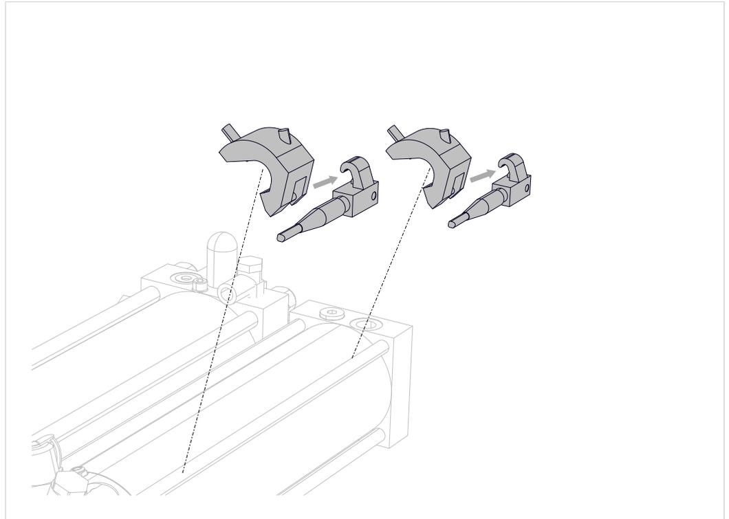
Abb. 15 Positionssensoren für Hubabfrage für Vorhub und Rückhub montieren
