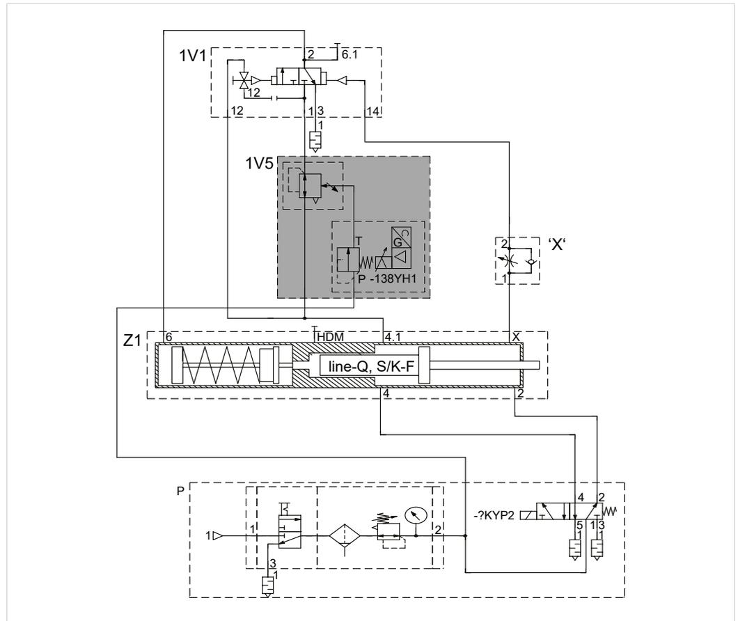
Abb. 10 Druckregelung in Krafthubleitung mit Proportionaldruckregelventil
