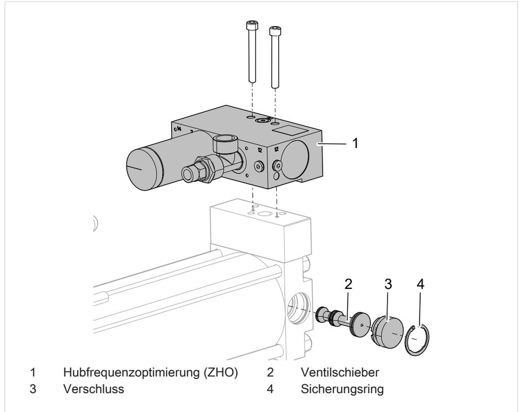
Abb. 20 Hubfrequenzoptimierung (ZHO) montieren
