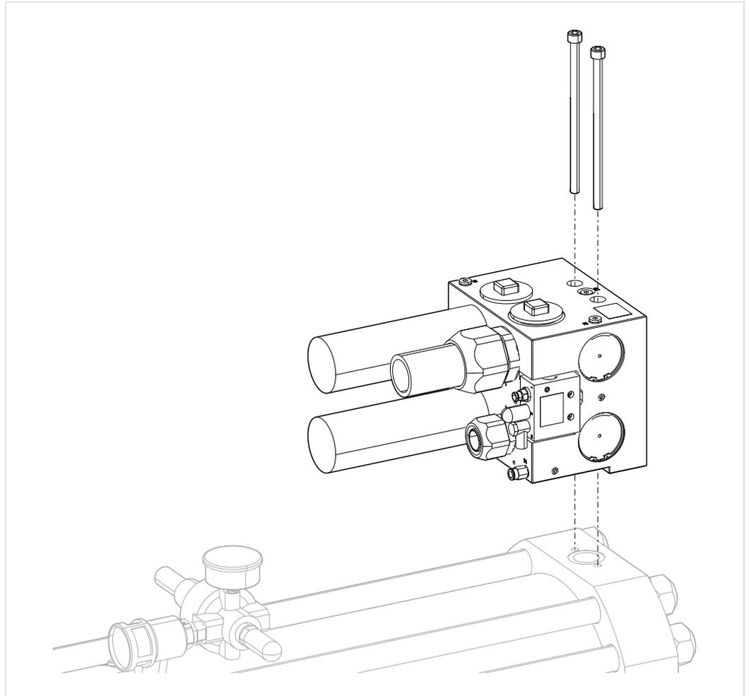
Abb. 21 Hubfrequenzoptimierung (ZHO) montieren
