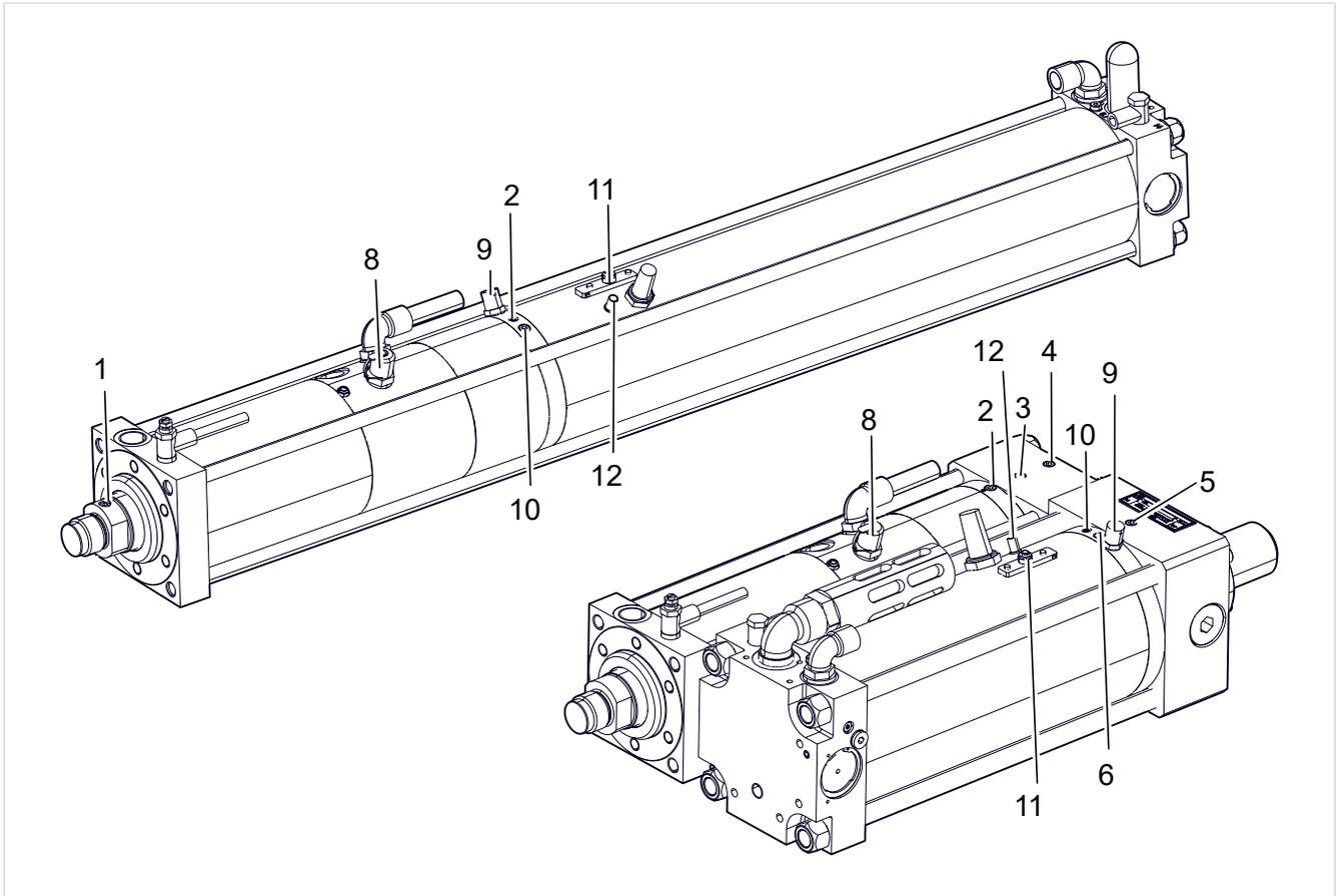
Abb. 26 Öl nachfüllen und Antrieb entlüften
