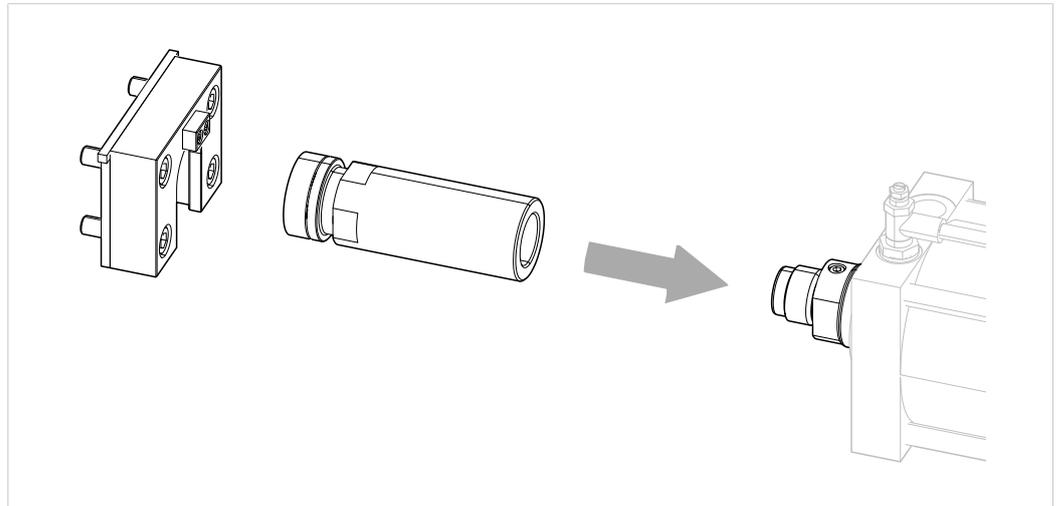
Abb. 23 Werkzeugkupplung (ZWK) montieren
