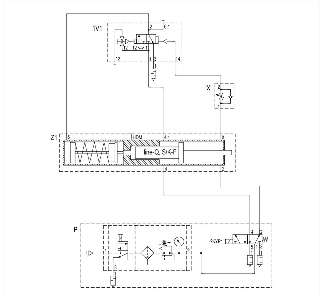
Abb. 8 Ansteuerung nach Staudruckverfahren für Kraftpaket mit mechanischer Feder
