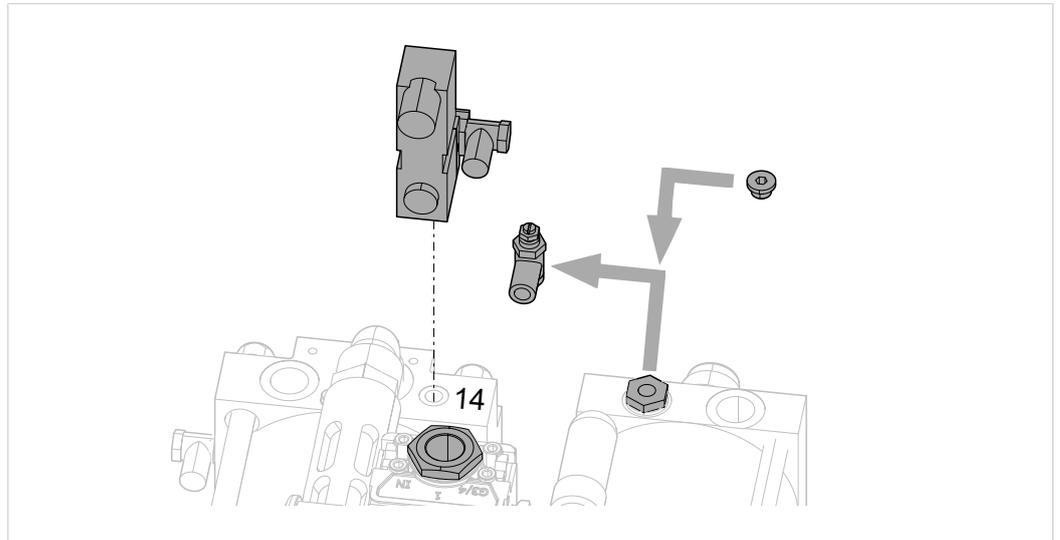
Abb. 17 Externe Krafthubzuschaltung (ZKHZ) montieren
