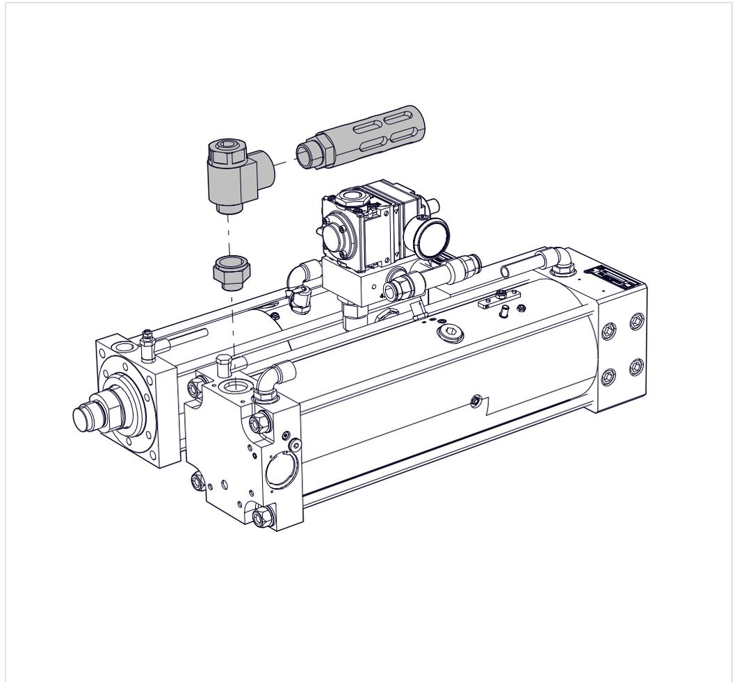
Abb. 22 Geschwindigkeitsreduzierung für Krafthubentlüftung montieren
