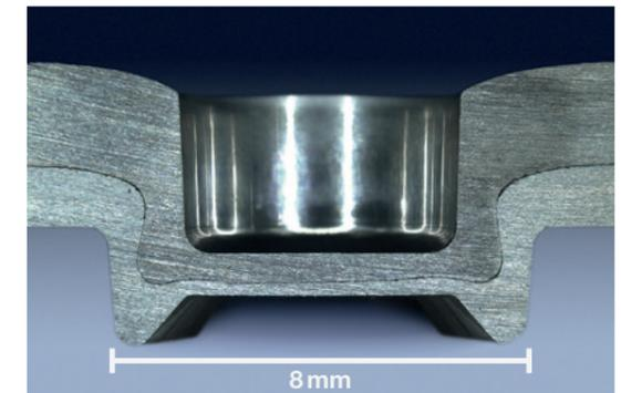
Durch das Schliffbild (Schnitt durch den Punkt) lässt sich unter dem Mikroskop die Ausformung eines Clinch-Punkts analysieren und bei Bedarf optimieren.
