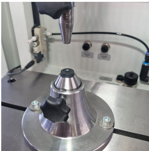
Bild 3: Ventilsitz N1, Arbeitsvorgang: Ventilsitz mit Kraftmessung
