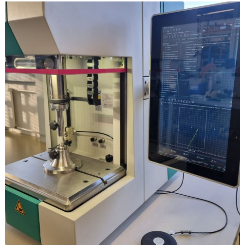
Bild 2: Schmiernippel Rundkopf Messing, Arbeitsvorgang: Bördelung mit Weg und Kraftmessung
