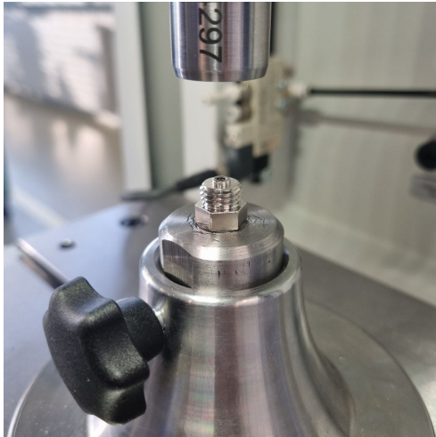
Bild 2: Schmiernippel Rundkopf Messing, Arbeitsvorgang: Bördelung mit Weg und Kraftmessung
