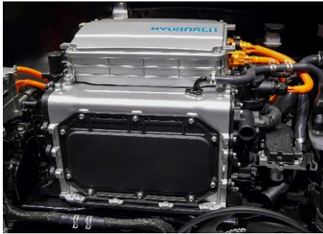
Bild 3: Brennstoffzellen-Stacks wandeln den Wasserstoff aus dem Tank und Sauerstoff aus der Luft in elektrischen Strom um.
