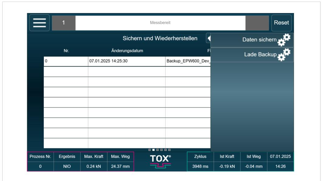
Ermöglicht das Sichern und Wiederherstellen der Konfiguration und Prozessdaten. Im Untermenü kann dazu **Daten sichern**, oder **Lade Backup** ausgewählt werden.
