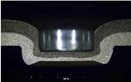
**Bild 2:** Der Clinch-Prozess stellt eine druckknopfartige, formschlüssige Verbindung von zwei oder drei Blechlagen in einem Kaltumformprozess her.
