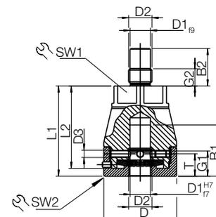
**Achtung:** Presskraft wird über die Bundfläche (min. ØD) übertragen!
