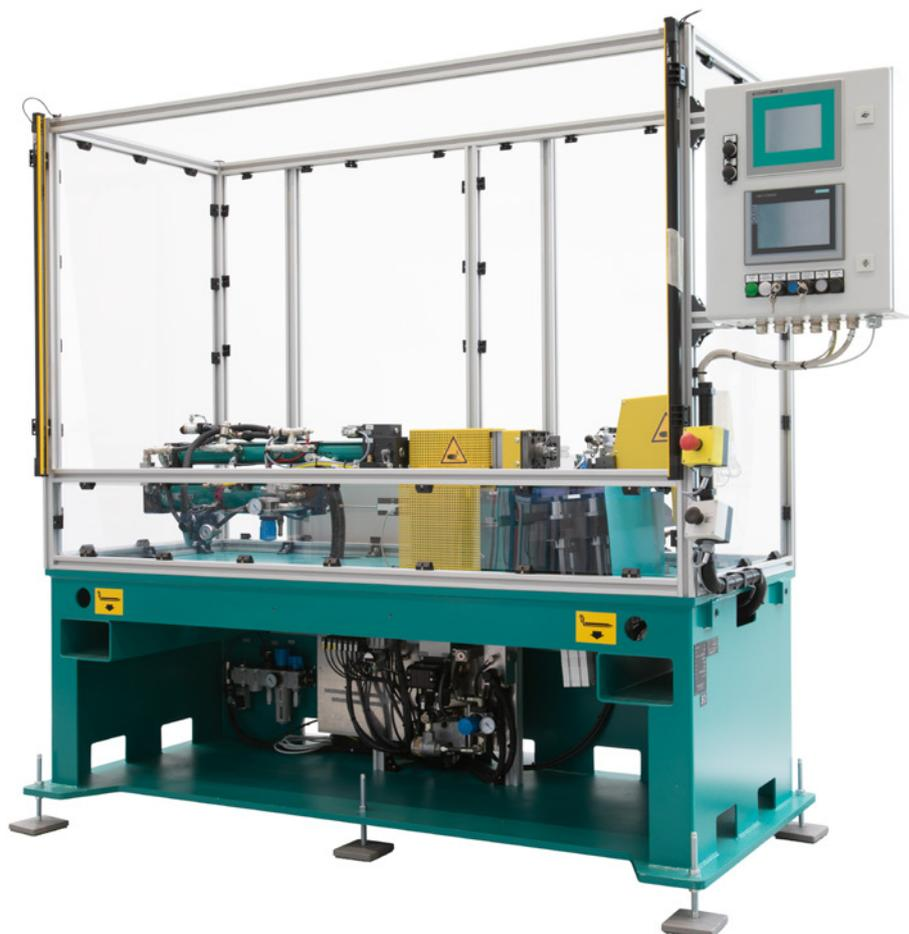
Einpressmaschine für Turboladegerhäuse
