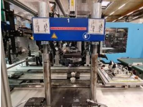
Bild 3: Mit den ElectricDrive-Antriebssystemen lassen sich sämtliche Einstellungen für die Heißprägeschritte vorab programmieren, eine manuelle Nachjustierung ist nicht mehr nötig.
