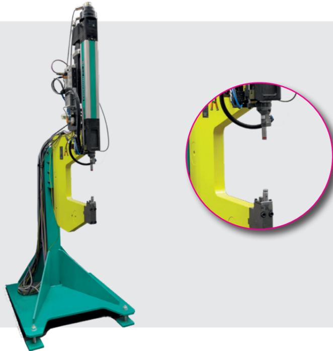
**TOX® Presse** mit teilautomatisiertem Werkstück-Handling zum Setzen von 16 Nieten in ein Kupplungsgehäuse.
